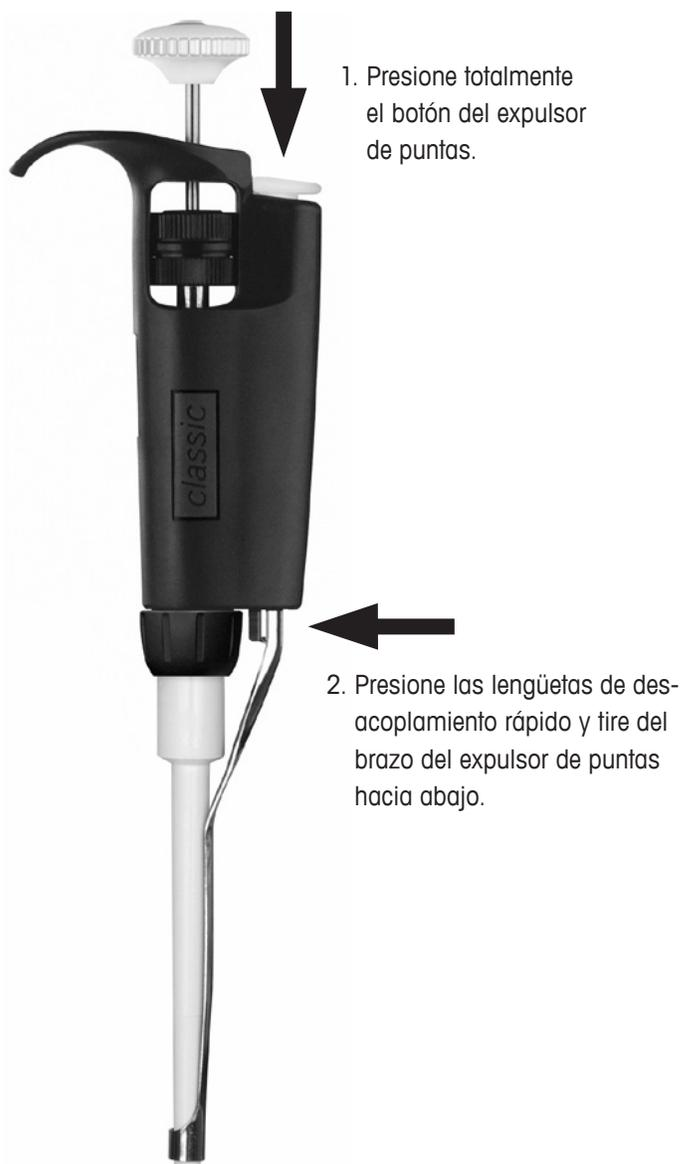
Figura 5: Extracción del brazo del expulsor de puntas
